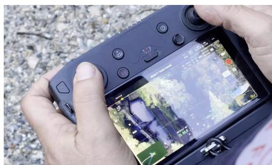
Imagen 16: Mando de control de un dron.
